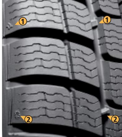
*Stege im Profilgrund dienen als Verschleißindikatoren und deren Lage ist außen am Reifen markiert: ① Grenze für Sommer- (1,6 mm) sowie für Winterreifen (4 mm) ②.*
