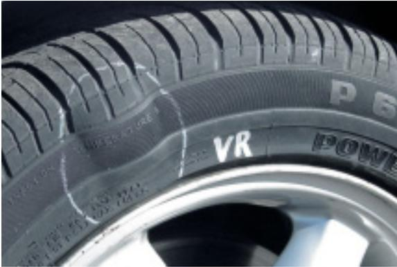
che führt (bei schlauchlosen Reifen) zu schleichendem Luftverlust. Vor allem aber kann **Feuchtigkeit** bis zum Gürtel vordringen, und der ist aus Stahl und kann zu rosten beginnen. Der Reifen wird zu einer Art **Zeitbombe**. Die Cordfäden der Karkasse können zwar nicht rosten, aber die geringste Beschädigung schwächt hier den festen Verbund und führt zum Defekt.
